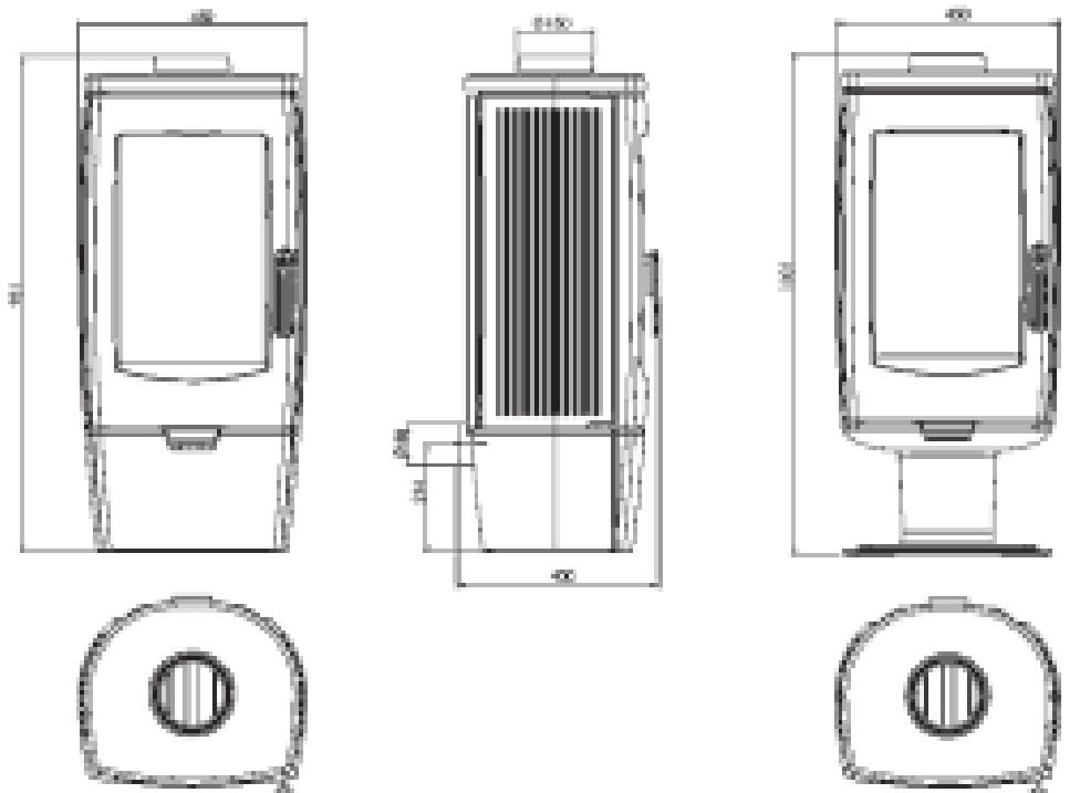
Le foyer est doté d'une porte en verre céramique transparent résistant à des températures allant jusqu'à 700 C. Ce type de verre offre une vue imprenable sur le feu tout en empêchant l'apparition d'étincelles et de fumée. Le foyer est équipé d'un régulateur d'air primaire et secondaire qui régule le débit de l'air de combustion, et donc aussi sa puissance.
